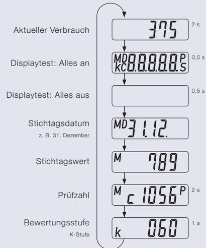
Der HKVE caloric 5/5.5 ist mit einer Bewertung von K60 programmiert worden. Die Berücksichtigung der Heizkörperwärmeleistung erfolgt durch Bewertung der Anzeigeeinheiten mittels UF=Umrechnungsfaktor im Zuge der Heizkostenabrechnung und wird auf Ihrer Einzelabrechnung in einer Übersicht dargestellt.
